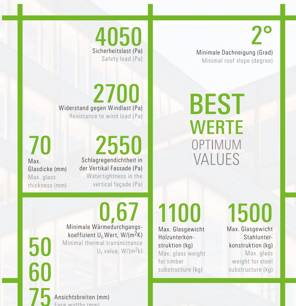
Das cradle to cradle zertifizierte System Schüco AOC erreicht dank optimierter Wärme- und Schalldämmwerte Passivhaus-Niveau. Die Schüco AOC.TI punktet zudem durch die nachwachsende Ressource Holz in der Unterkonstruktion.
