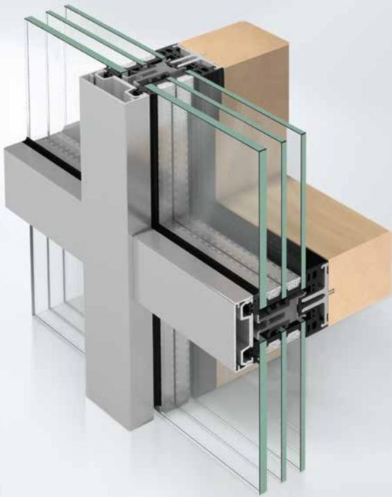
**Leistungsfähig** dank hoher Lastaufnahme. Für Glasfassaden und Lichtdächer mit maximaler Transparenz. Die Schüco AOC bietet ein skalierbares Glasträgerprogramm. Auf Holz sind so Glasgewichte je Riegel bis 1.100 Kilogramm möglich, auf Stahl sogar bis 1.500 Kilogramm – sowohl für Vertikalfassaden als auch für Lichtdächer in den Ansichtsbreiten 50, 60 und 75 Millimeter.
